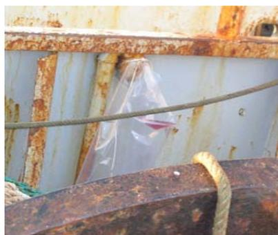
En los suspiros de los tanques de combustible se colocarán bolsas de plástico, sin que éste afecte a la seguridad de a bordo, con el fin de evitar que ante un reboso se produzca un vertido de combustible al mar. Debajo de la conexión habrá una bandeja de goteo con capacidad suficiente para contener un derrame.
